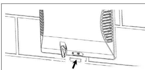
**3** Schraubenabdeckung einsetzen
